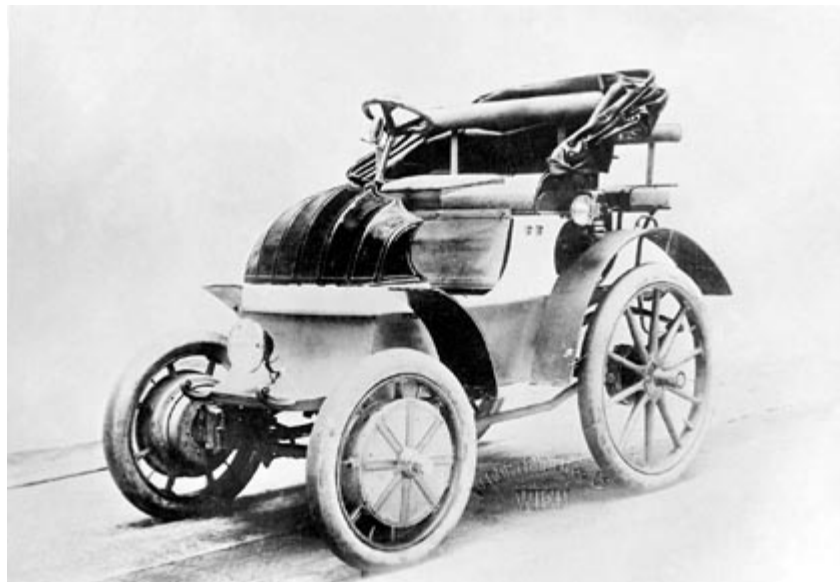
La Lohner-Porsche: Questo veicolo elettrico è stato presentato per la prima volta in occasione dell'Esposizione mondiale di Parigi ne 1900. I motori elettrici integrati nei mozzi delle ruote anteriori raggiungevano una potenza di 2,5 PS, la batteria consentiva di percorrere 50 km con un unico carico.
