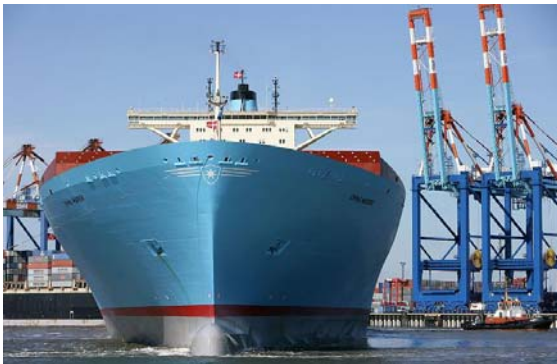
La nave portacontainer "Emma Maersk". Con i suoi 100.000 PS un tale mercantile trasporta fino a 13.000 container. I motori di queste navi sono oggi alimentati con gasolio pesante.
