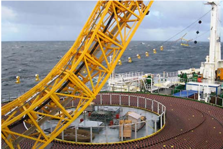
Carico di un cavo HVDC su una nave di trasporto
