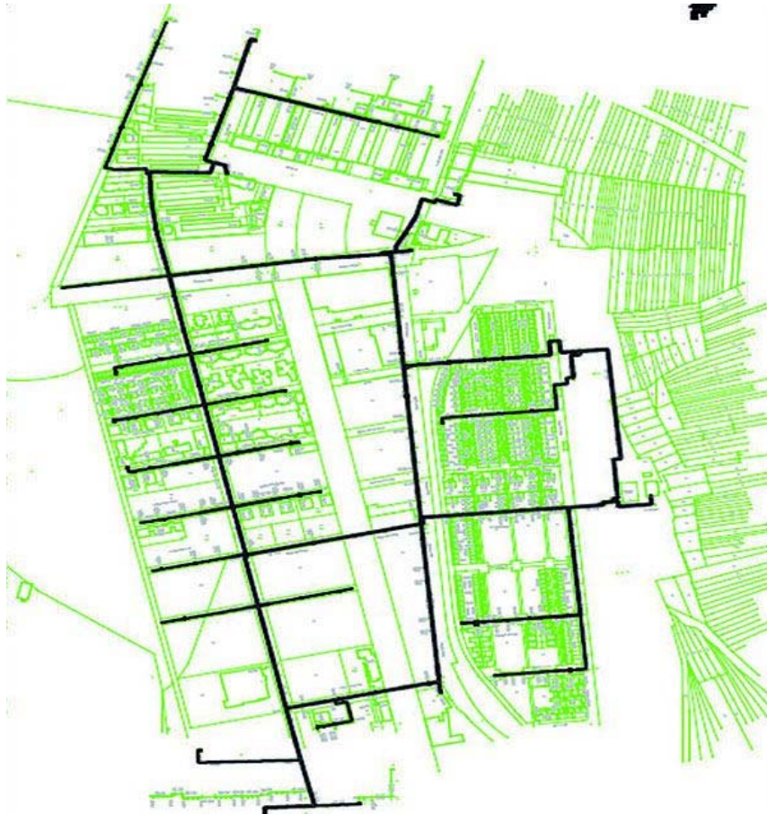
La rete di teleriscaldamento
