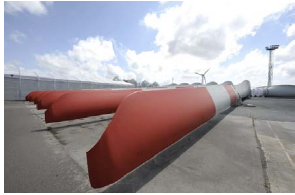
BARD-Gruppe Ogni pala ha una lunghezza di quasi 60 metri e pesa 28 tonnellate.
