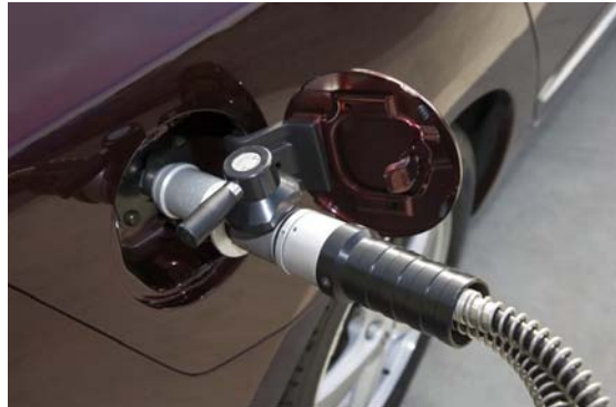
Fornitura di idrogeno gassoso.
