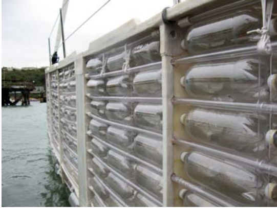
Bottiglie di plastica usate per rivestire lo scafo del catamarano. dpa
