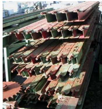
2012 Architecten Le travi d'acciaio dopo lo smontaggio della macchina tessile
