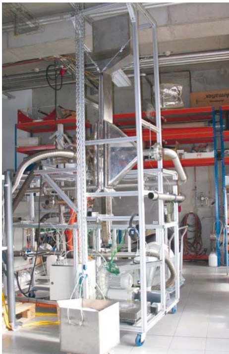
Solar-Institut Jülich Accumulatore di sabbia sperimentale del Solar-Institut di Jülich
