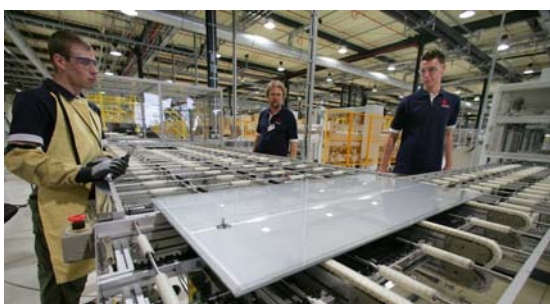
Produzione di moduli fotovoltaici a film sottile presso la First Solar
