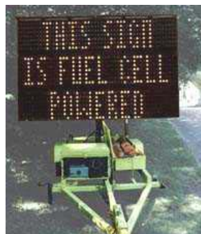
Segnaletica stradale alimentata da una cella a combustibile
