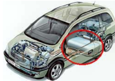
Serbatoio per idrogeno liquido in un veicolo con celle a combustibile della Opel
